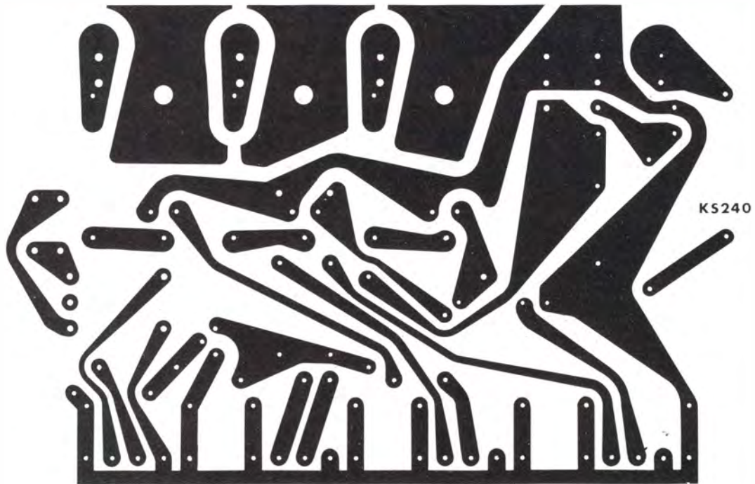
Fig. 2 - Basetta a circuito stampato in scala 1 : 1 - KS240.
